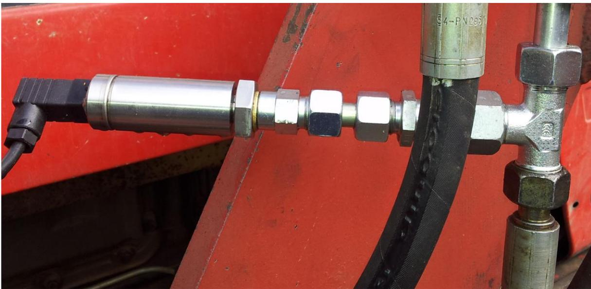
Beispiel für den Einbau in die Heckhydraulik-Druckleitung
